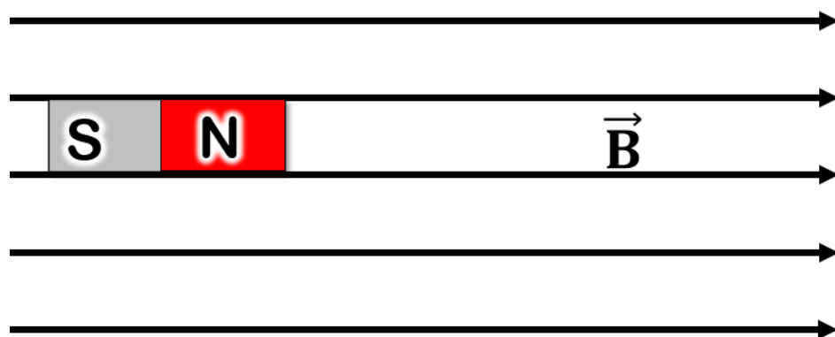
Figura A: polo norte do ímã no sentido do campo magnético.
